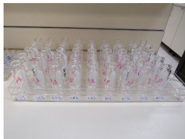
19. ábra: Mintaelőkészítés folyamán használt segédeszközök (mintatartó, fémkupak, gumidugó, mintatartó tálca üvegcsével, mintatartó üvegek, referencia anyagok) (forrás: saját képek)
