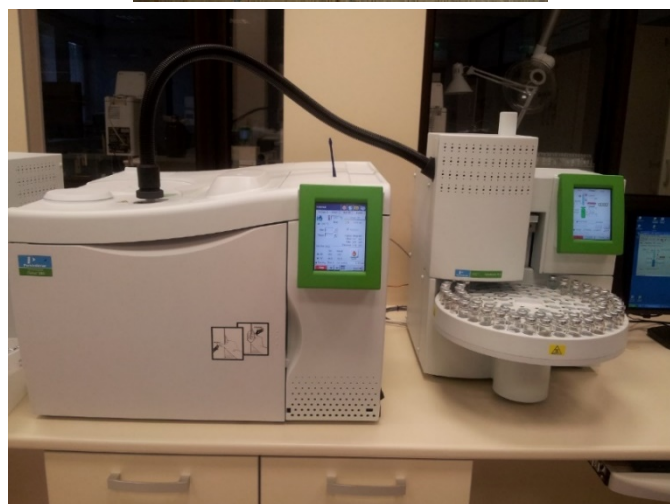
6. ábra: Véralkohol vizsgálatok mérőműszere (HS-GC-FID) a régi 1990-es években és a jelenleg használt vizsgálatoknál (forrás: saját képek)
